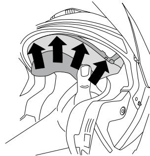
4. Attachez les 2 boutons pression de la partie arrière de la coiffe. Insérez ensuite les 2 boutons pression situés à l'arrière des mousses de joue dans les œilletts latéraux de la partie arrière de la coiffe.
