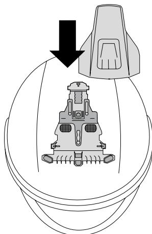
4. Betätigen Sie anschließend den Belüftungsschieber nach vorn und zurück um eine optimale Funktion der Belüftung zu gewährleisten.
