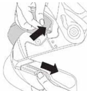
3. Halten Sie das Sonnenvisier mit einer Hand fest und schieben Sie mit der anderen Hand den Schieber nach hinten.
