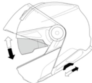
La posición máxima de apertura de la pantalla solar se puede configurar utilizando el limitador. El limitador está en el borde de la guía que acciona la palanca de la pantalla solar
