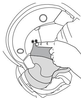
3. Befestigen Sie das Stirnpolster an den 4 Halterungen und verbinden Sie die Druckknöpfe mit den entsprechenden Steckvorrichtungen.
