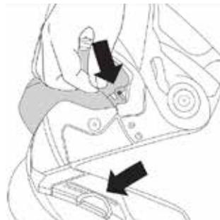
2. Deslice la pantalla solar detrás del pestillo. Repita este paso del otro lado.
