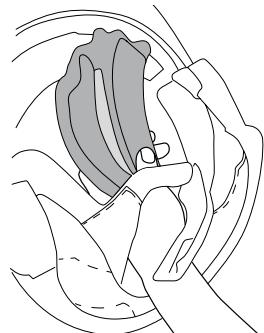
4. Lösen Sie die 2 Druckknöpfe des hinteren Kopfpolsters. Achtung, hier muss zusätzlich der hintere Druckknopf des Wangenpolsters gelöst werden.
