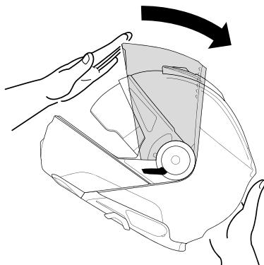
2. Betätigen Sie die Federelemente rechts und links unterhalb der Visiermechanik in Richtung Visieröffnung.
