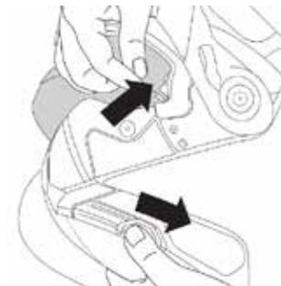
4. Avec le doigt, poussez l'extrémité de l'embase vers l'avant jusqu'à l'enclenchement du pare-soleil. Répétez cette opération de l'autre côté.
