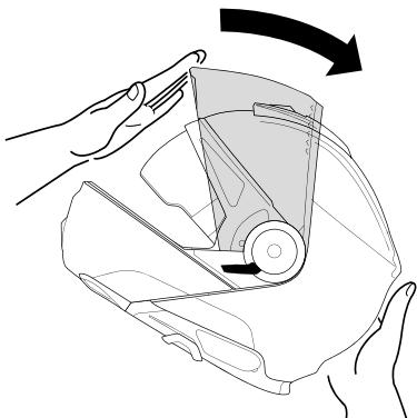
2. Opere las palancas a la derecha e izquierda debajo del mecanismo de la pantalla en la dirección del apertura de la misma.
