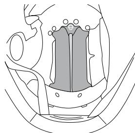
2. Verbinden Sie die 2 Druckknöpfe des Seitenpolsters mit den entsprechenden Steckvorrichtungen. Bitte beachten Sie dabei die Kennzeichnung des rechten und linken Seitenpolsters.
