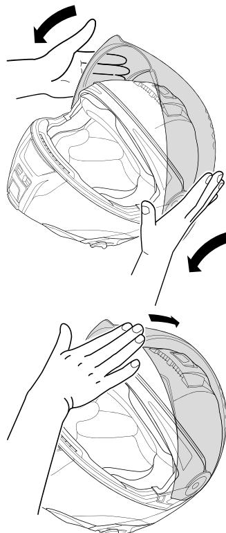
3. Überprüfen Sie die Funktion der Visiermechanik, indem Sie das Visier einmal schließen und bis zum Anschlag öffnen.
