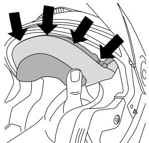
2. Lösen Sie alle 4 Druckknöpfe des oberen Kopfpolsters sowie jeweils die 2 Druckknöpfe der linken und rechten Seitenpolster.
