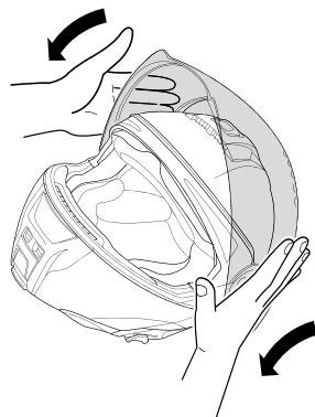
3. Verificare il funzionamento della meccanica della visiera chiudendo quest'ultima e riaprendola fino all'arresto.
