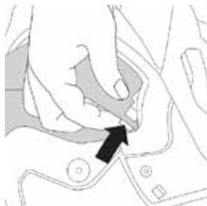
4. Drücken Sie den Riegel mit den Fingern nach vorne bis dieser einrastet. Wiederholen Sie diesen Schritt auf der anderen Seite.
