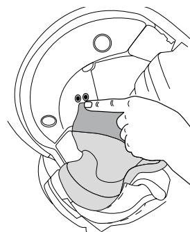
3. Sujeta la almohadilla a la frente con sus 4 soportes y conecte los pines a sus enganches correspondientes.
