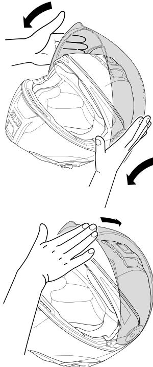
3. Controle el funcionamiento de la visera cerrándola una vez y volviéndola a abrir hasta el tope.
