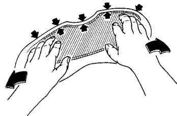
5. Vérifiez que la visière anti-buée repose intégralement contre l'écran visière. Si ce n'est pas le cas, la tension sur la visière antibuée peut être accrue ou réduite par rotation des boulons excentriques.
