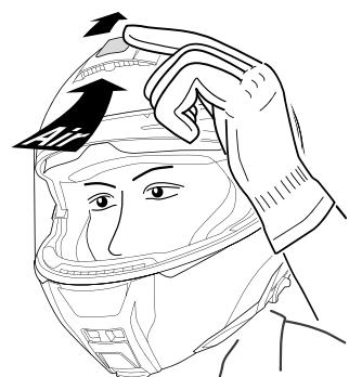
Per regolare l'intensità della ventilazione, sulla presa d'aria è integrato un cursore, comodamente regolabile anche indossando i guanti. Spingendo indietro il cursore fino al primo scatto si attiva la ventilazione parziale, mentre un suo ulteriore spostamento all'indietro corrisponde all'apertura completa della presa.
