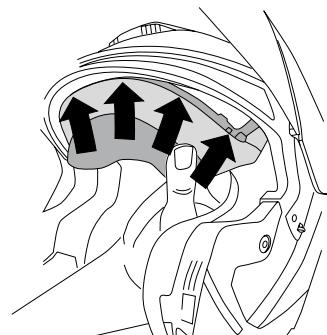
4. Verbinden Sie die 2 Druckknöpfe des hinteren Kopfpolsters mit den dafür vorgesehenen Steckvorrichtungen. Drücken Sie dabei das offene Ende über den hinteren Druckknopf des Wangenpolsters.
