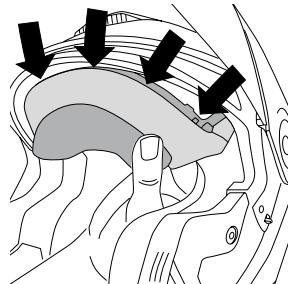
2. Détachez les 4 boutons pression de la partie centrale de la coiffe, puis les 2 boutons maintenant chaque coussinet latéral situé à gauche et à droite.
