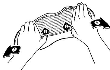
3. Agarrar la pantalla antivaho por detrás con el dedo índice y el corazón y levantarla de la pantalla exterior. En esa posición se pueda tirar de la pantalla antivaho ligeramente con el pulgar sacándola del perno de sujeción.
